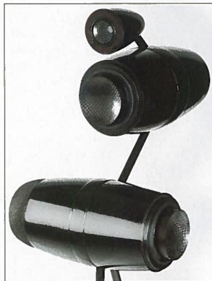
Ein flankierender Subwoofer muss nicht sein: In kleinen bis mittleren Räumen zaubern die Push-Pull-Zylinder einen erstaunlich beherrschten Bass. Die Antriebsspulen treiben die Carbon-Kuppeln dabei in einen Ferrofluid-Ölfilm.
