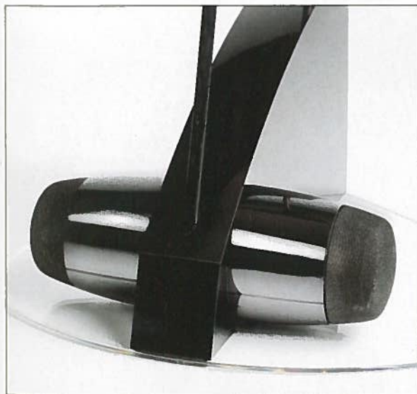
Ein flankierender Subwoofer muss nicht sein: In kleinen bis mittleren Räumen zaubern die Push-Pull-Zylinder einen erstaunlich beherrschten Bass. Die Antriebsspulen treiben die Carbon-Kuppeln dabei in einen Ferrofluid-Ölfilm.
